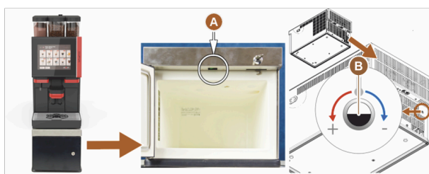
ilustracja: Włączanie i ustawianie chłodziarki dolnej
