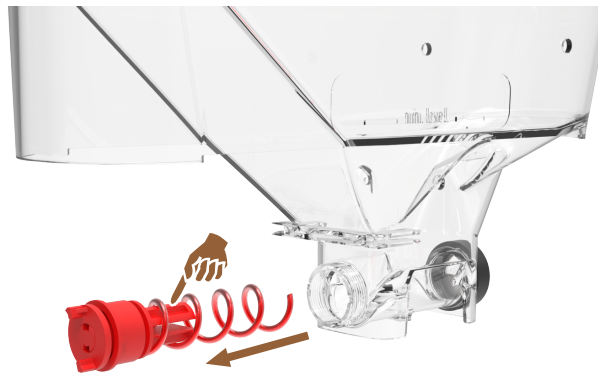
Fig. 209: Retirer l'unité d'alimentation
