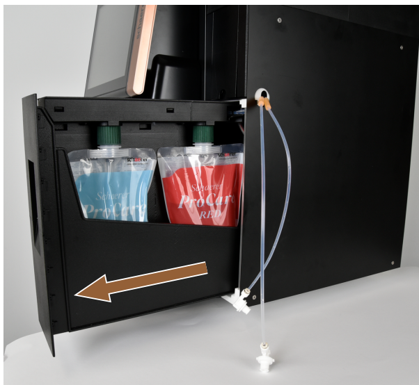
Fig. 58: Sortir le tiroir avec récipient de récupération
