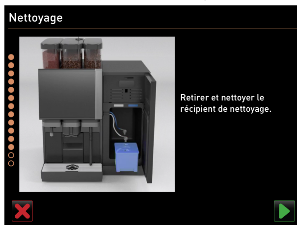
Fig. 145: Enlever le récipient de nettoyage
