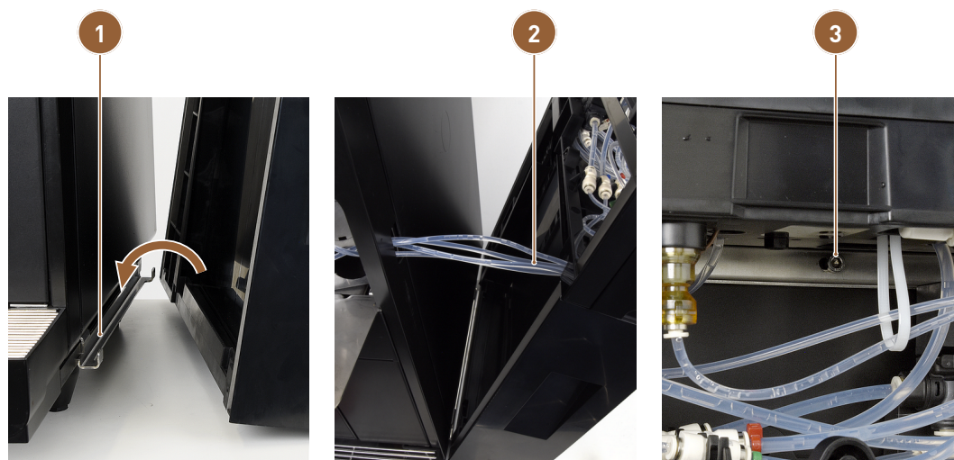
Fig. 41: Fixer l'unité ProCare à la machine
