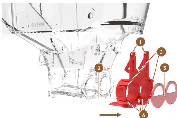
Joon.: Topelt-pulbrimahuti Twin: Doseerimiselementide eemaldamine
