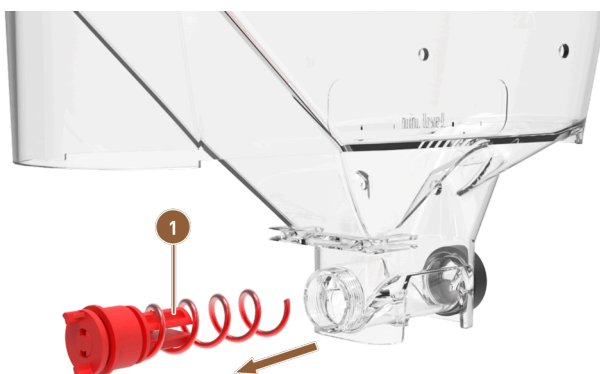
Joon.: Standardne pulbrimahuti: Konveieriüksuse eemaldamine
