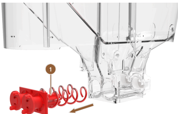
Joon.: Topelt-pulbrimahuti Twin: Konveieriüksuse eemaldamine
