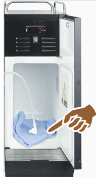
صورة: تنظيف وحدة التبريد
