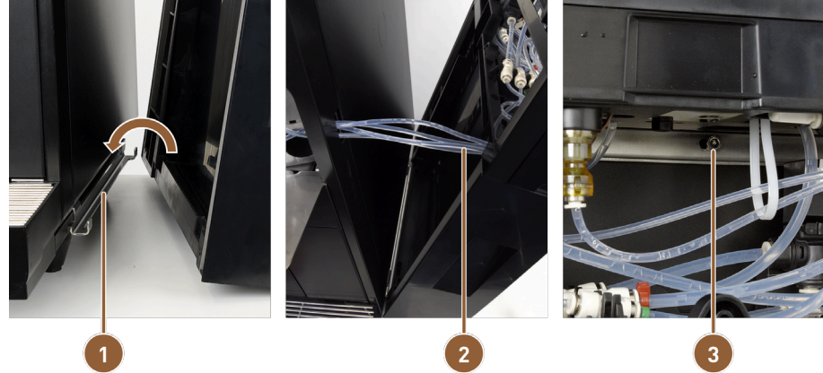
صورة: تثبيت وحدة ProCare بالماكينة
