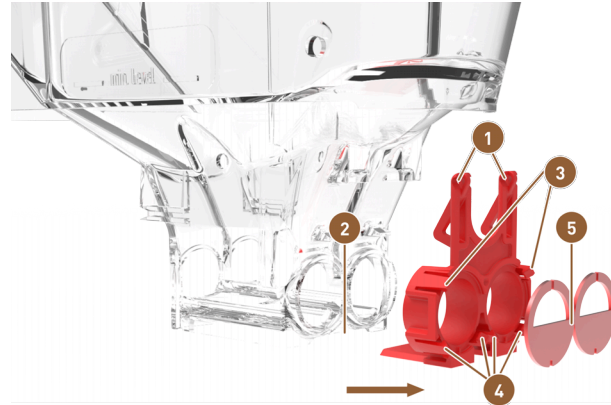
صورة: حاوية المسحوق المزودة: إزالة عناصر المعايرة
