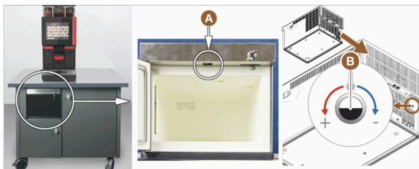
Att.: Zem letes novietojamā dzesēšanas aparāta ieslēgšana un iestatīšana
