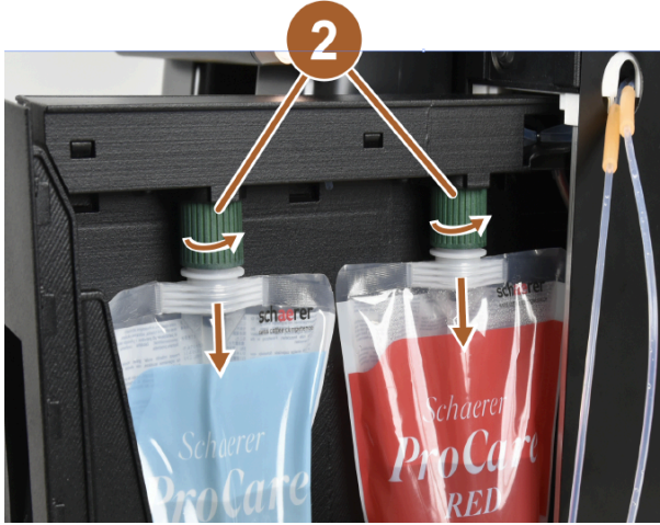
Şekil: Temizlik poşetinin çıkartılması
