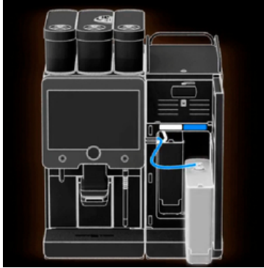
Şekil: Süt kabının çıkartılması
