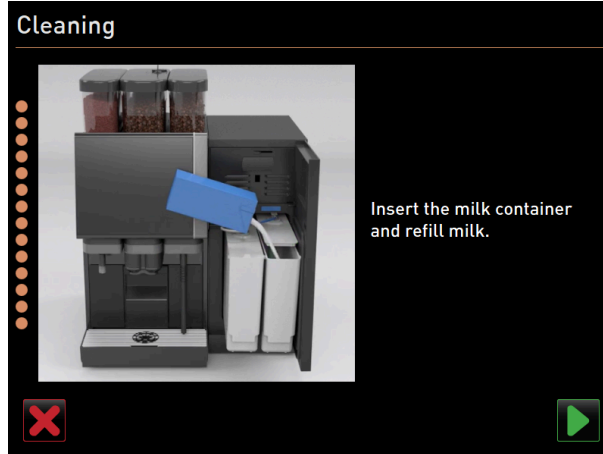
Şekil: Süt kabının yerleştirilmesi
