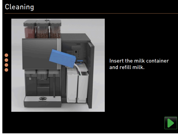
Şekil: Süt kabının yerleştirilmesi
