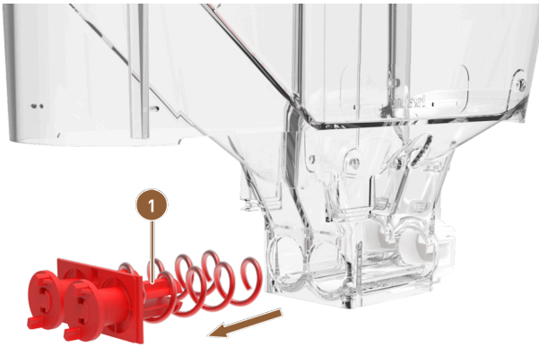
Şekil: Twin toz kabı: Sevk ünitesinin çıkartılması
