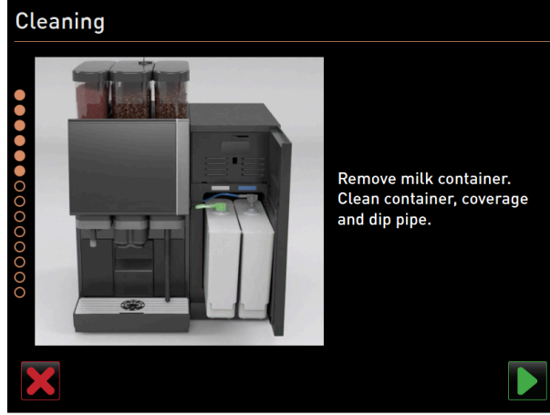
Şekil: Süt kabının temizlenmesi (opsiyon)
