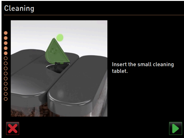
Şekil: Temizlik tabletinin yerleştirilmesi
