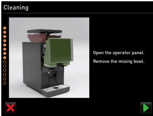
Şekil: Kontrol panelinin kaldırılması
