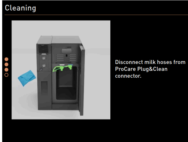
Şekil: Süt hortumlarının Plug&Clean bağlantılarından çıkartılması
