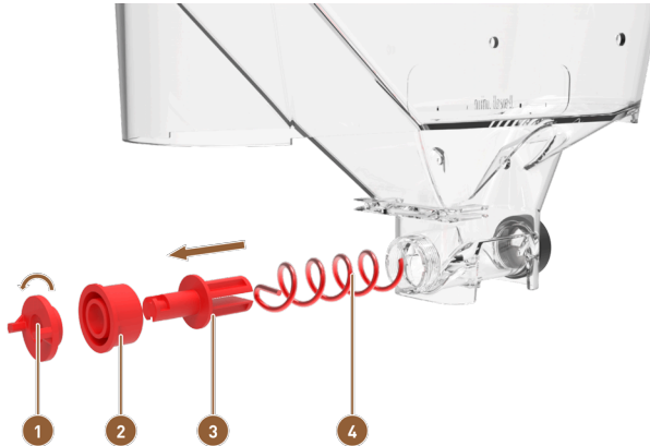
Şekil: Standart toz kabı: Sevk ünitesinin parçalarına ayrılması
