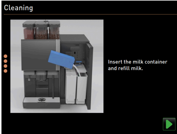
Şekil: Süt kabının yerleştirilmesi
