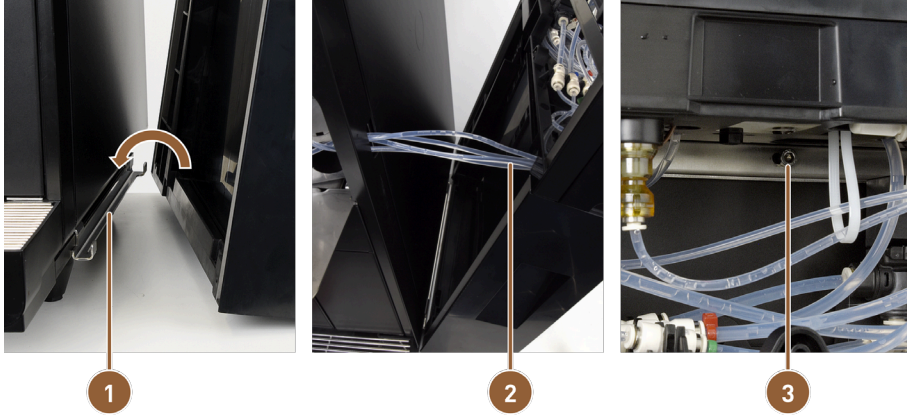
Şekil: ProCare ünitesinin makineye sabitlenmesi
