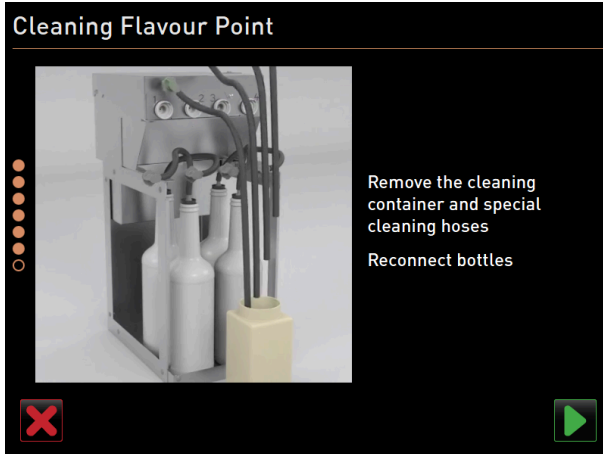
Şekil: Temizlik kabının tekrar çıkartılması
