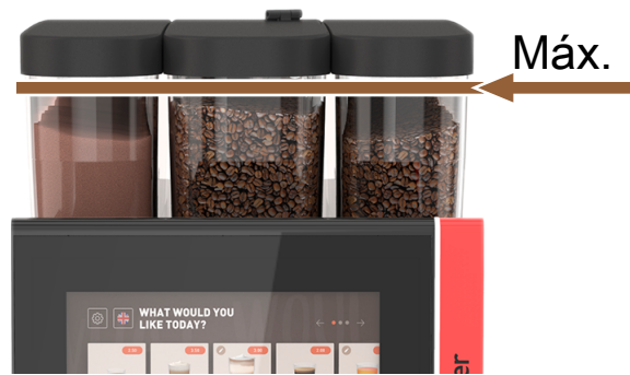
Fig. 50: Depósitos de granos y de polvo con cantidad de llenado máxima
