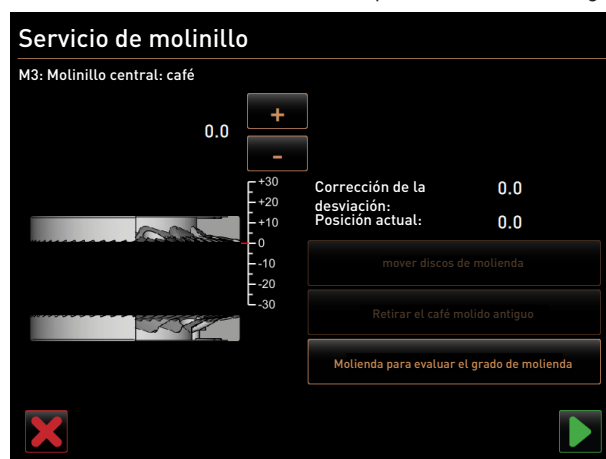
Fig. 266: Ajustar el grado de molienda: molienda para evaluar el grado de molienda
