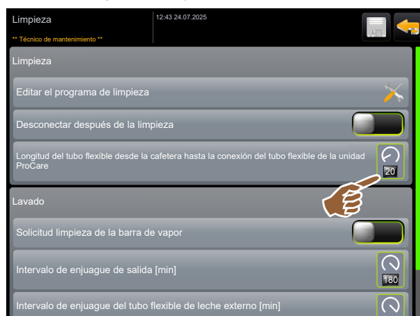
Fig. 43: Ajustar la longitud de las mangueras para la unidad ProCare
