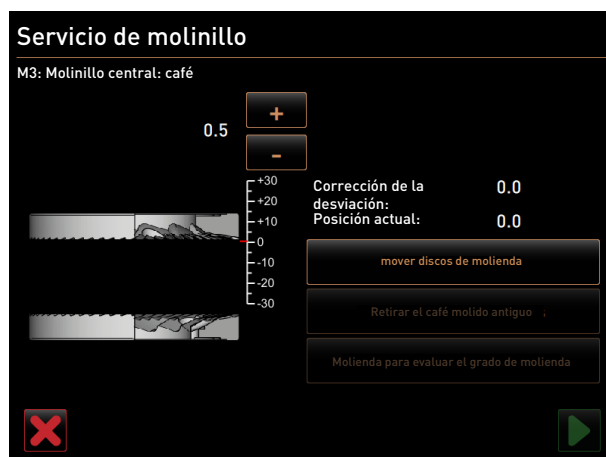
Fig. 267: Ajustar el grado de molienda: mover discos de molienda
