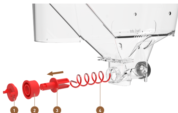
Fig. 210: Desmontar la unidad transportadora
