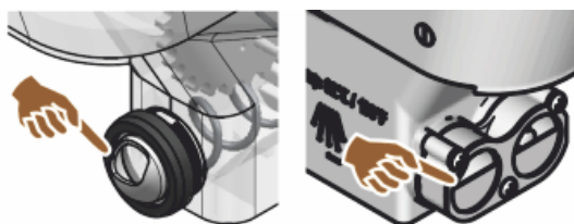
Figura: Allineamento della piastra di dosaggio nella versione standard e Twin sul lato di erogazione del contenitore per prodotti in polvere
