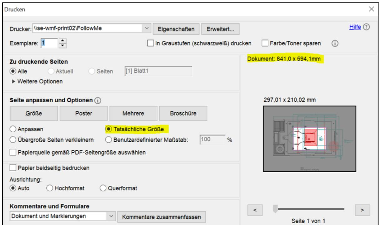
Jegliche andere Einstellung führen zu einer verzerrten Skalierung, falschen Maßen und somit zu einer fehlerhaften Bohrschablone!
