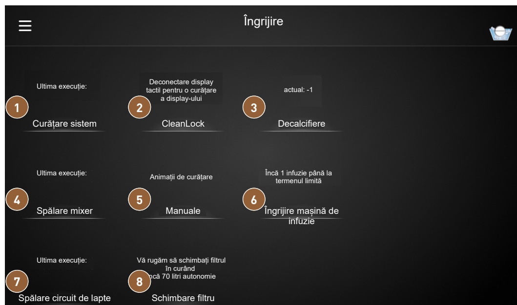
Fig. 54: Ecran îngrijire cu întreținerea curentă a unității de infuzie
