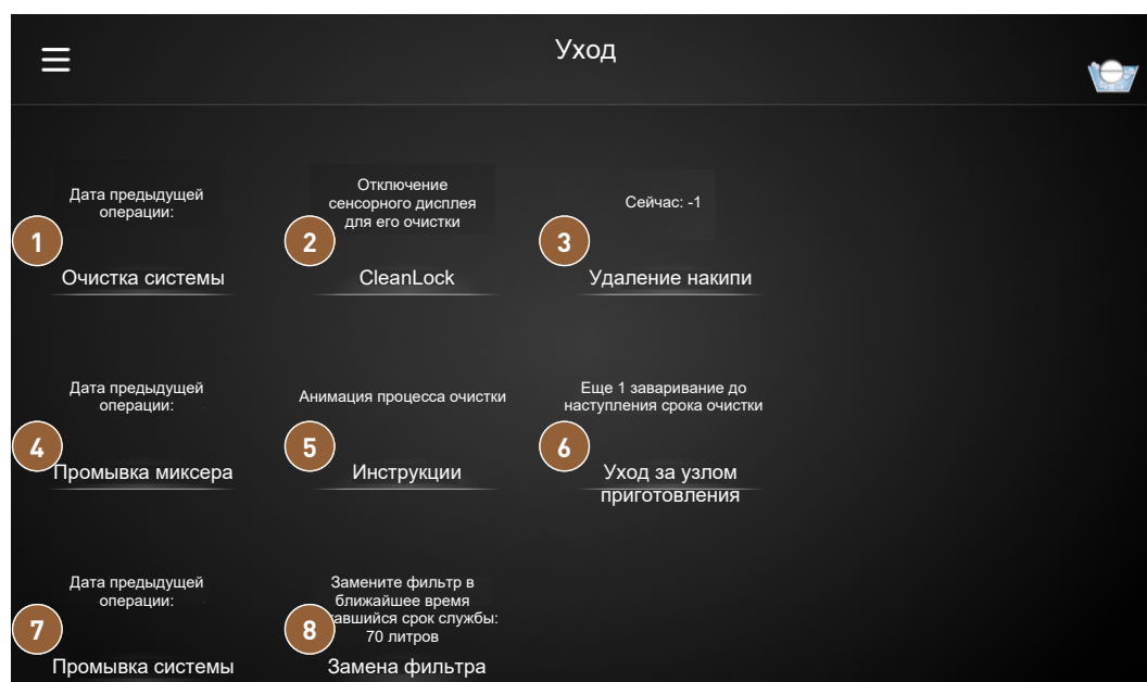
Рис. 54: Экран «Уход» с опциями техобслуживания узла приготовления
