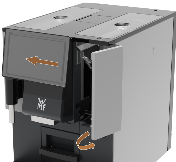
Рис. 41: Дисплей слева, дверца открыта
